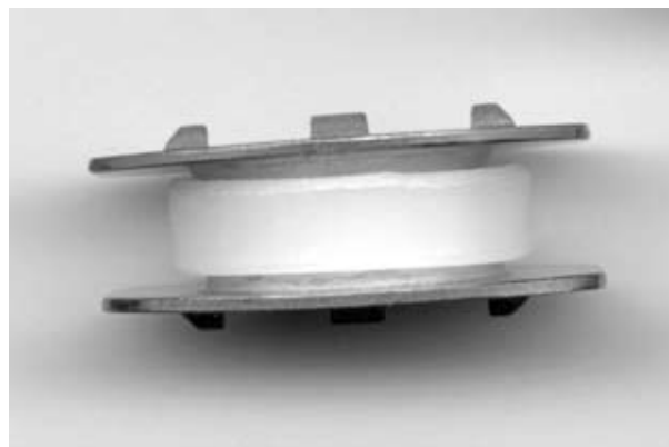
Рис. 5. Поперековий протез міжхребцевого диска у зібраному вигляді
